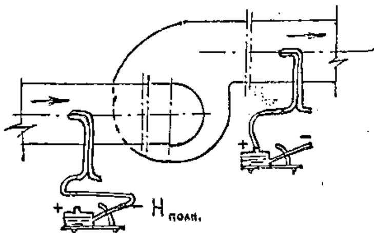
б) при измерении полного давления
