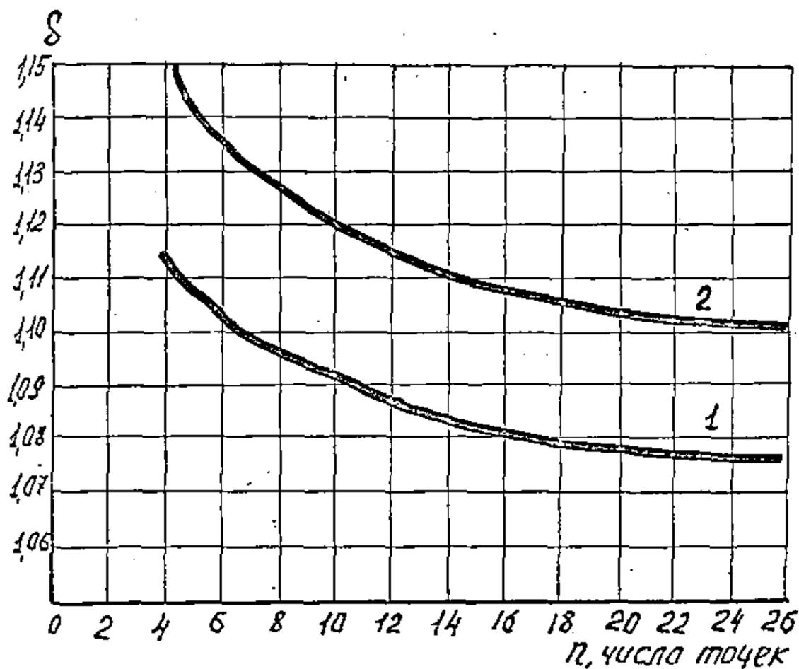
Рис. 2. График поправочных коэффициентов на величину расхода воздуха по воздуховоду при измерении по методу равноотстоящих точек: 1 — для металлических воздуховодов, 2 — для воздуховодов из строительных конструкций.
