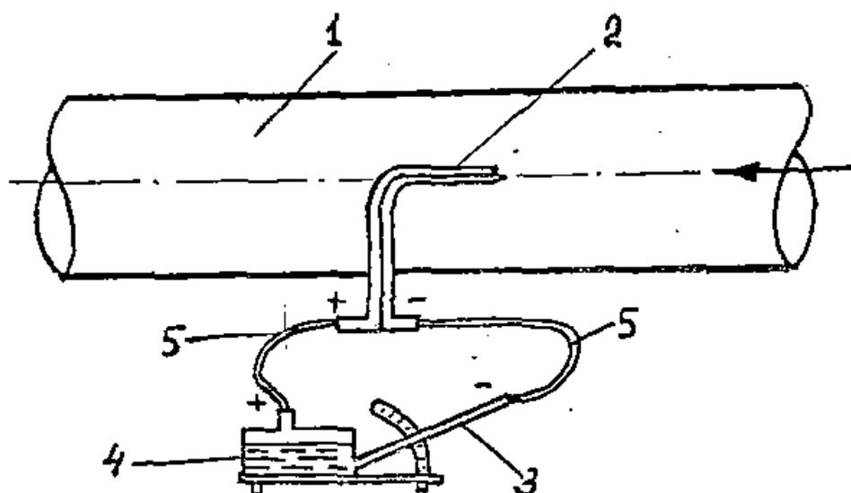
Рис. I. Схема присоединения пневмометрической трубки к микроманометру при измерении динамического давления в воздуховоде: 1 - воздуховод нагнетательный или всасывающий, 2 - пневмометрическая трубка, 3 - наклонная трубка микроманометра, 4 - резервуар микроманометра, 5 - резиновые шланги.
