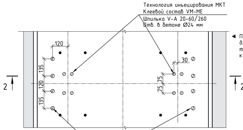
План привязки отверстий для крепления ограждения типа "ТРАНСБАРЬЕР" к монолитному цоколю
