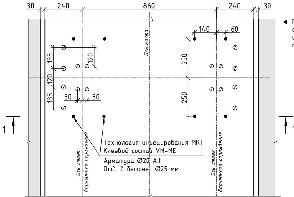
План привязки отверстий для объединения монолитного цоколя с существующим пролетным строением
